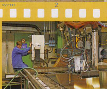
Le marquage des tôles d'al (de 4 mm pour le pont à 30 mm pour la quille) est la première étape de la construction.
