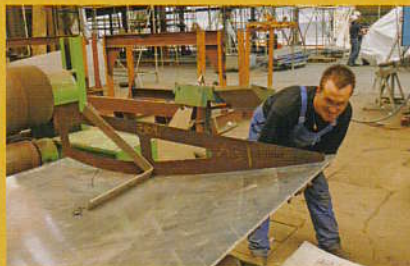
Le blason permet de s'assurer que la tôle a pris la bonne courbure. Les chaudronniers travaillent au millimètre...
