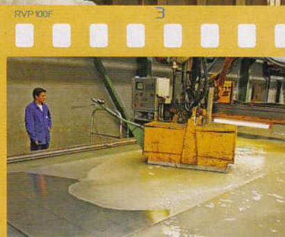
La découpe plasma, un outil CMN, se fait à l'aide d'un logiciel dans un bain d'eau pour diminuer la pollution et la perte.
