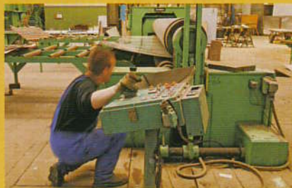
Le formage des tôles à l'aide d'une rouleuse demande beaucoup de minutie car il faut donner deux courbures.
