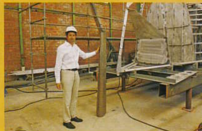
L'étrave des voiliers Allures est constituée d'une crash box, d'un renfort de cadène de 22 mm et d'un solide cône.
