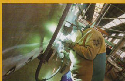
Le montage et le soudage requièrent un grand savoir-faire: il en va de la sécurité du bateau.
